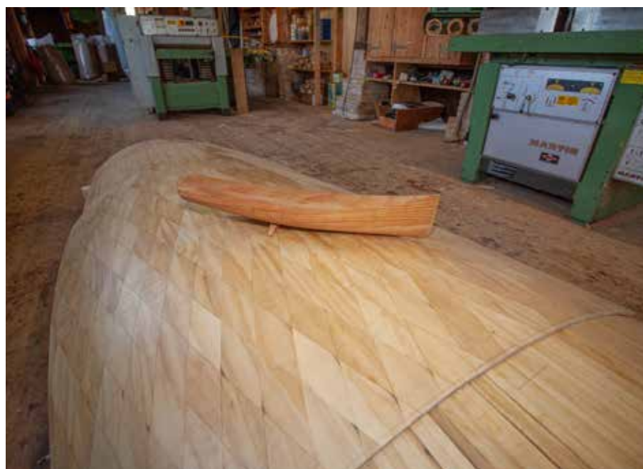
EEN HALFMODEL VAN DE WERFFBOAT 21 OP ENKELE GEVORMDE PROEFDELEN. GOED TE ZIEN ZIJN DE LATTEN EN DE RUITJES.
